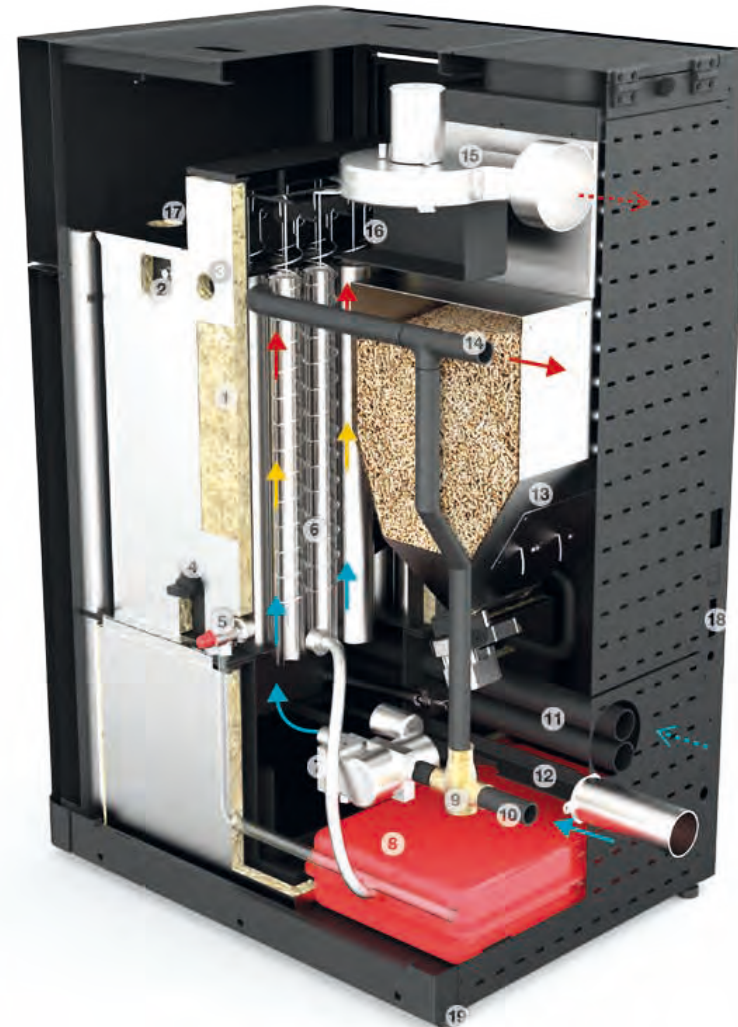
B. VISTA EM CORTE POSTERIOR DA CALDEIRA AUTOMÁTICA E PRINCIPAIS COMPONENTES
